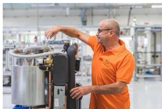
Assemblage du chariot thermodynamique de la BOOSTHEAT.20
